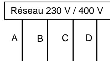
On mesure 230 V entre les fils A et B d'une part, et 400 V entre les fils B et D d'autre part.
