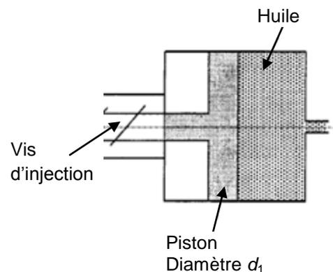
1.1. Après avoir montré que la section du piston vaut  $S_1 = 78,5 \text{ cm}^2$ , calculer l'intensité de la force  $F_1$  exercée par l'huile sur le piston. Quelle serait la masse d'un corps de même poids ?
