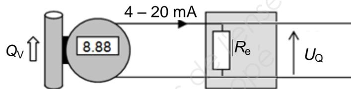
2.1. Sachant que la vitesse d'écoulement dans la conduite varie entre les valeurs 0,010 et 10  $\text{m}\cdot\text{s}^{-1}$ , indiquer, en justifiant, si ce débitmètre est adapté à cette situation.
